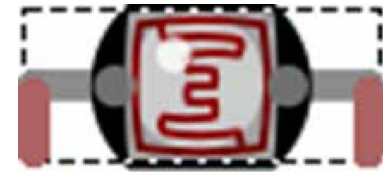
Φωτοαντίσταση (Light-Dependent Resistor, LDR)
