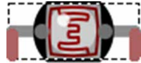
Φωτοαντίσταση (Light-Dependent Resistor, LDR)
